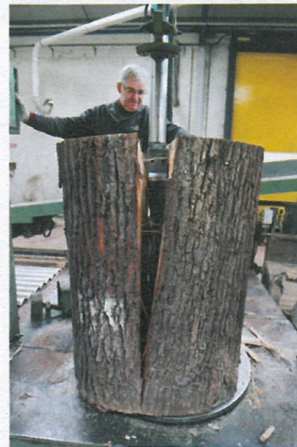
La fendeuse partage les troncs en quatre quartiers. Le bois est ensuite coupé en merrains conformément au patron ci-contre
