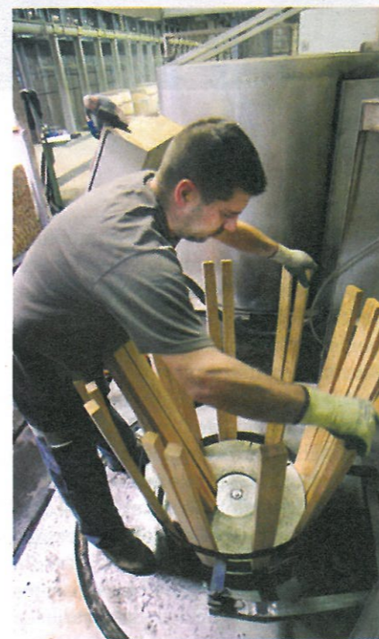
Les douelles sont ajustées autour d'un cercle métallique. La technique est appelée mise en rose
