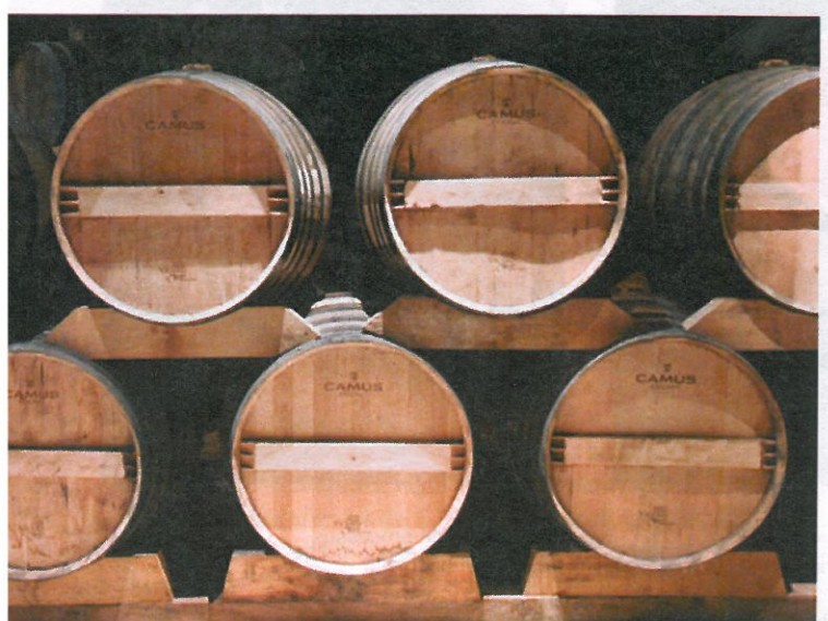
Le marquage au laser des barriques est une des dernières étapes avant l'emballage et le transport vers le chai d'adoption
